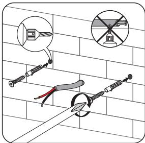
1 根据灯具吊挂孔距在墙上打孔，并装上墙塞和螺丝
