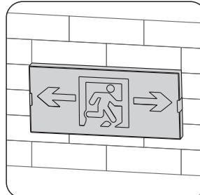
3 接通电源，然后按灯具安装顺序进行编址，并在控制器中进行模拟试验灯具是否正常
