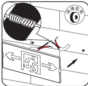
2 将接线图线正确接线，并用绝缘胶带做好防护处理
