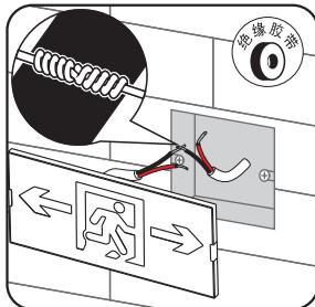
2 将接线图线正确接线，并用绝缘胶带做好防护处理，将灯具挂入底盒螺丝上
