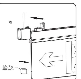
将垫胶粘贴于灯具背面,再将灯具安装于螺钉上
