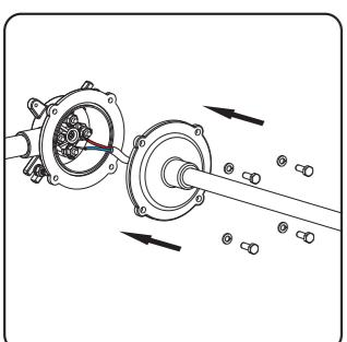
将电源线连接于端子上,并用螺母锁紧接线盒面盖
