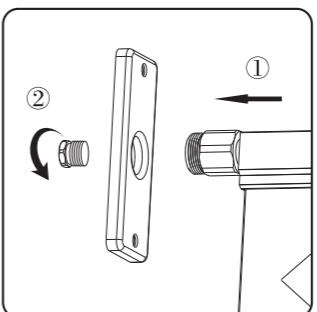
①将侧装配件安装于出线端的螺丝上
