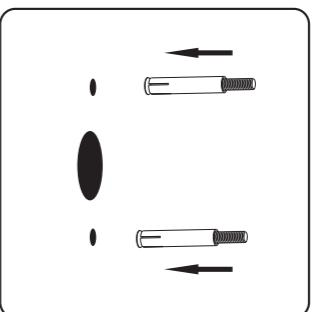
在墙体根据配件孔位钻孔,并安装好膨胀螺丝
