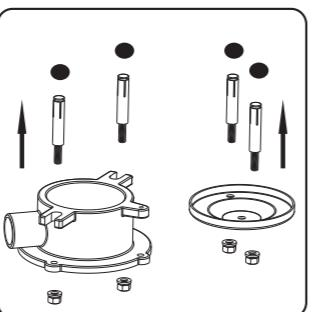
根据吊装配件和防爆接线盒的孔位将其用膨胀螺丝固定在天花板上
