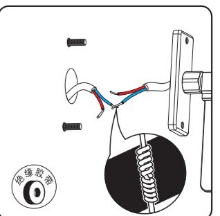
连接电源线,将用绝缘胶带做好防护
