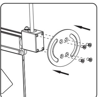
将侧装配件安装于出线端的螺丝孔上
