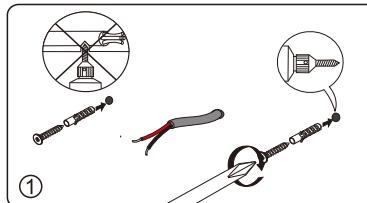
断开电源，根据灯具背板孔距在墙体上
