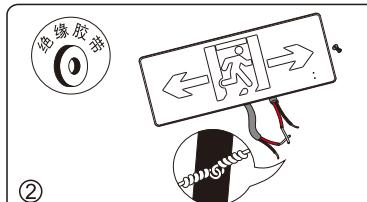
按接线图正确接线，并做绝缘防水处理
